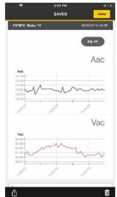
ข้อมูลที่รวบรวมโดย Fluke Connect สามารถมองชี้ถึงข้อผิดพลาดที่ไม่เกิดขึ้นประจำได้ ข้อมูลที่เก็บเป็นระยะสม่ำเสมอ สามารถใช้หาการเปลี่ยนแปลงเล็กๆ น้อยๆ ก่อนที่จะกลายเป็นปัญหาใหญ่ได้
